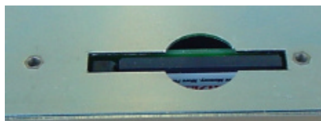
Abbildung 3: CompactFlash Slot einer Bedienstation mit eingeschobener CompactFlash Card und abgenommener Abdeckung
