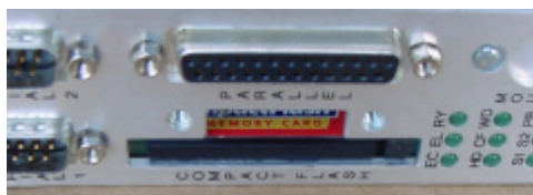
Abbildung 4: D500 CompactFlash Slot mit eingeschobener CompactFlash Card und abgenommener Abdeckung
